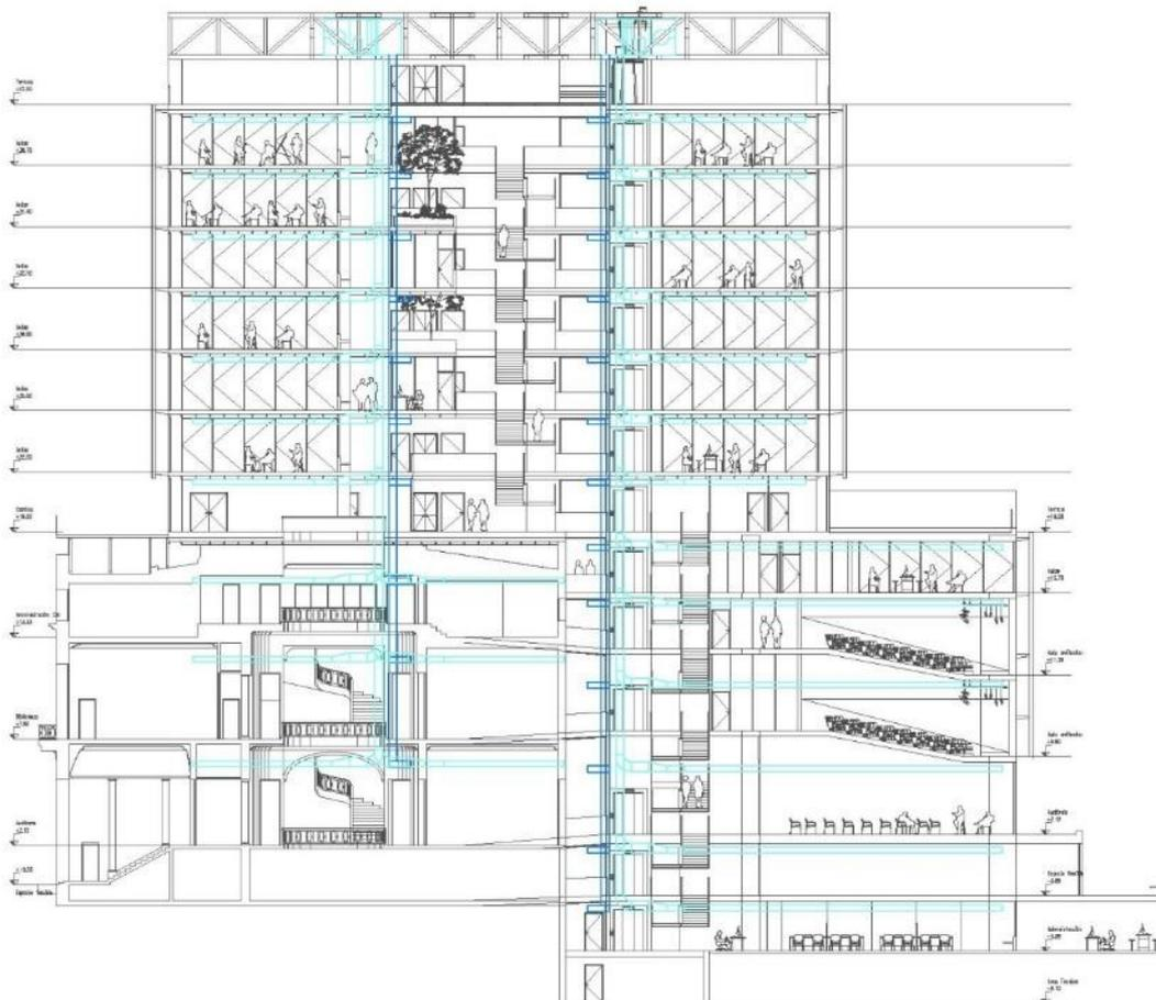
Sección Longitudinal donde se esquematiza el trazado de los conductos de climatización, los cuales se localizan en los pleno técnico planteados en la propuesta. Ver planta complementaria.
