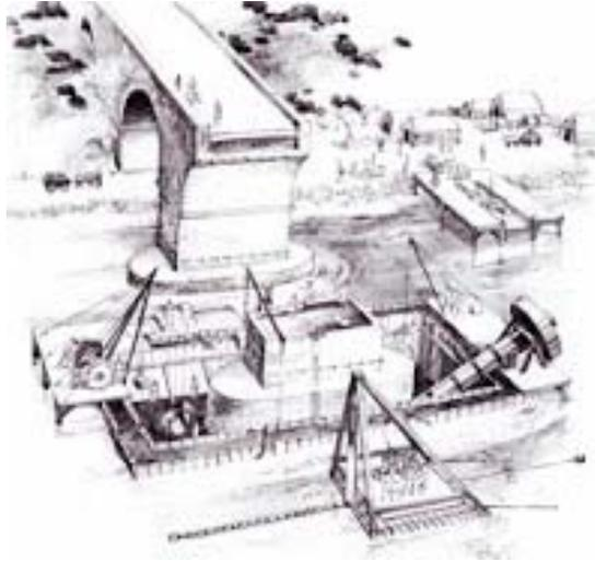
EMPLEO DEL TORNILLO DE ARQUIMEDES PARA EXTRACCIÓN DEL AGUA
