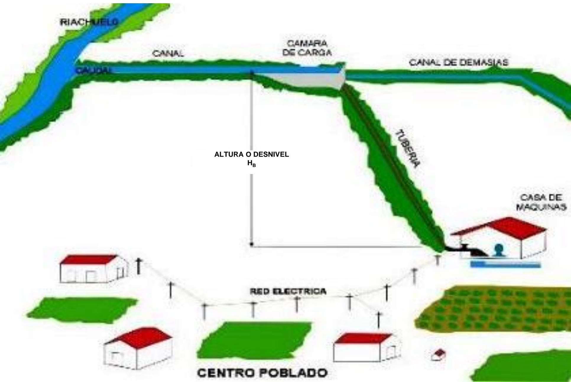
**CENTRAL HIDROELÉCTRICA DE DERIVACIÓN**
