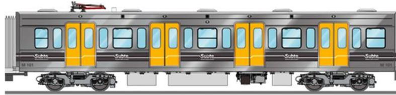
*Coche Motriz M, posee cuatro motores de tracción asíncrono trifásicos con rotor jaula de ardilla*
