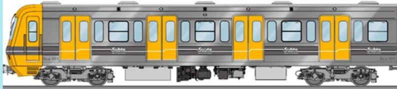
*Coche remolque con cabina de conducción (coches Rca y Rcb)*
