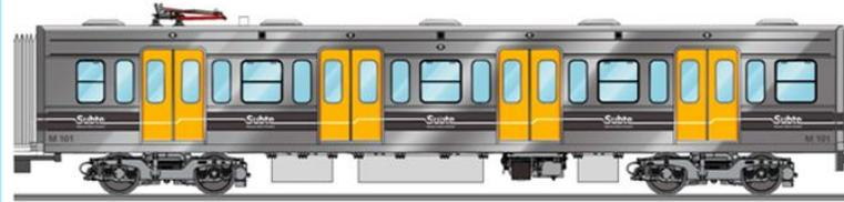
*Coche Motriz M, posee cuatro motores de tracción asíncrono trifásicos con rotor jaula de ardilla*
