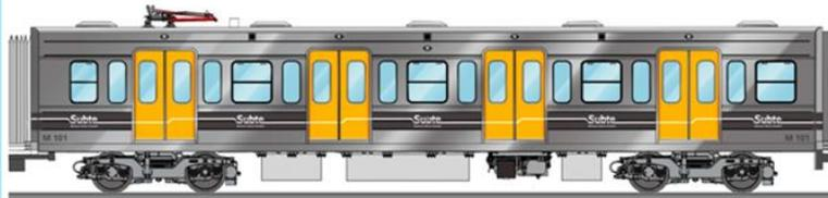
*Coche Motriz Mp, es igual que el M, excepto que tiene un pequeño tablero de conducción que se utiliza para realizar maniobras en el Taller cuando la formación se divide en dos triplas*
