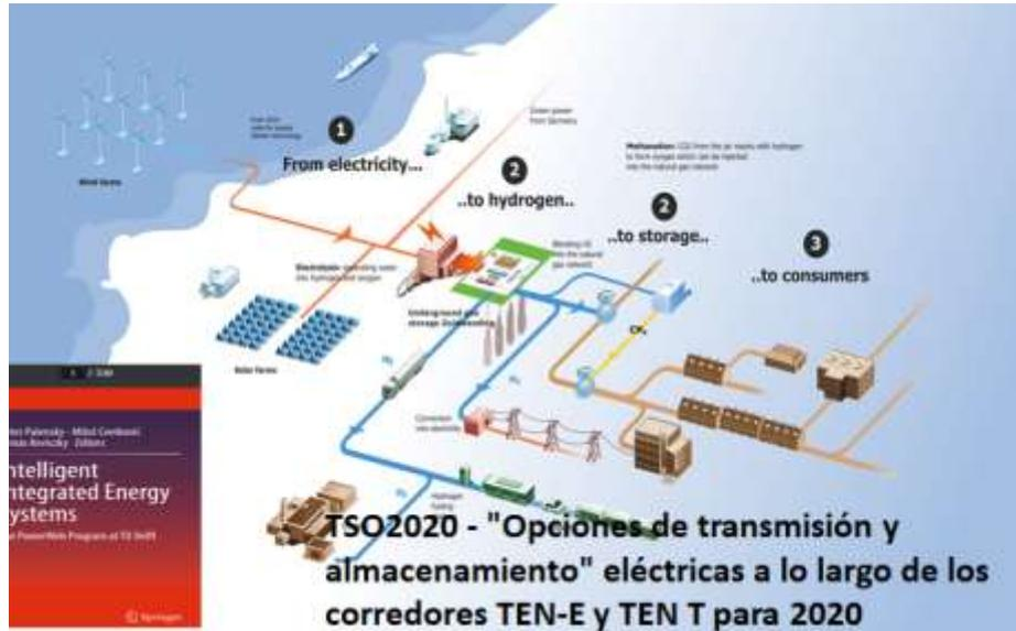
Como se observa en la lámina, se tiene en estudio un plan de generación eólica de electricidad en el mar y solar en tierra para producir hidrógeno por electrólisis e incorporarlo en un sistema de conducción energético que incluye gas natural del sistema europeo, electricidad de centrales de los diversos tipos y almacenamiento de energía.
